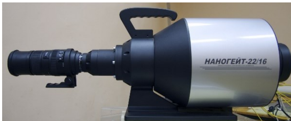
Рисунок 1 – 8-ми канальная 16-ти кадровая камера «НАНОГЕЙТ 22/16».
