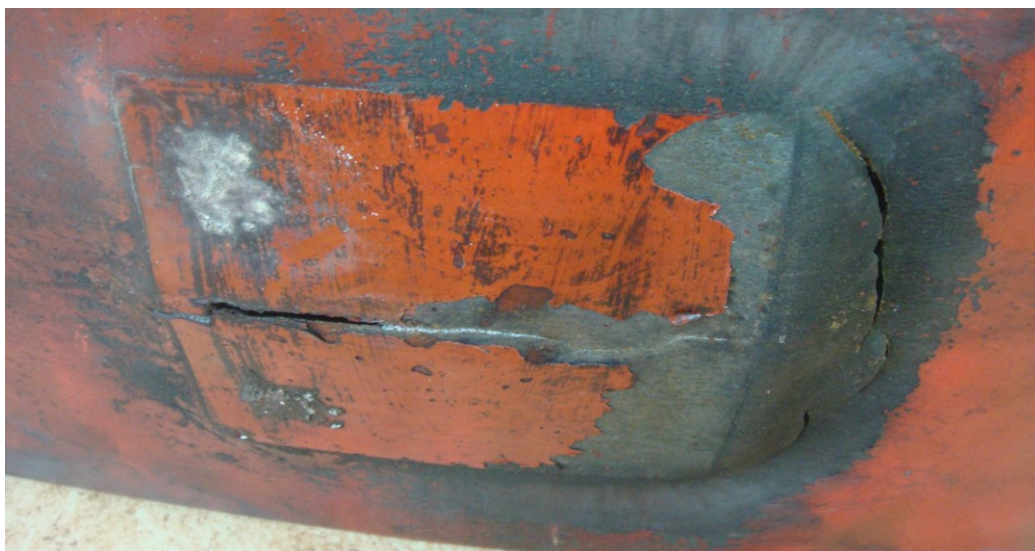
Рисунок 25 – Разрыв стальной пластины крупно
